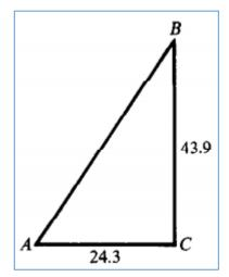
Primero encontramos el ángulo <CAB, utilizando la razón trigonométrica de tan (<CAB) =  $\frac{43.9}{24.3}$  = \_\_\_\_. Una vez calculado el valor, usamos la calculadora para encontrar la magnitud del ángulo, para lo cual realizamos el siguiente procedimiento.
