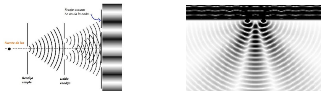
Fig. 68 Difracción de la luz, en el experimento conocido como el de la doble rendija
